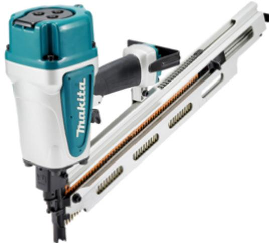
Potente e veloce chiodatrice con impugnatura morbida e sottile per il massimo comfort di utilizzo, protezioni in gomma che preservano da danneggiamenti. Ghiera di regolazione della profondità senza uso di attrezzi. Utilizza chiodi su stecca di plastica inclinati a 21° lunghezza da 50 mm (max 64pz) a 90 mm (max 73pz). Possibilità di scelta colpo singolo o con tocco.
