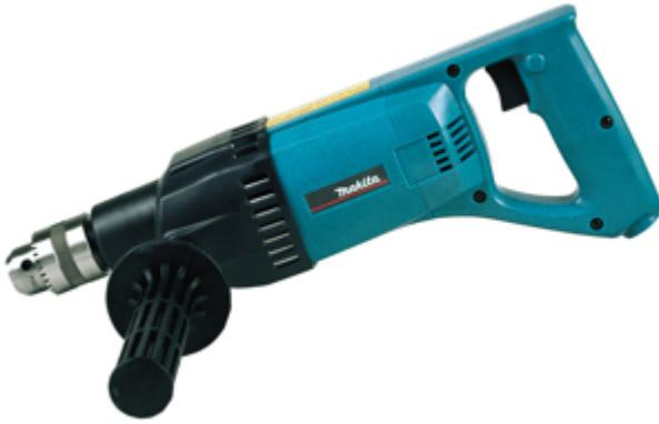
Trapano potente ideale per forare a secco con corone a settori diamantati, diametro da 20 a 152 mm. 2 funzioni: rotazione (0-1.500 g/min), rotazione+percussione (0-22.500 colpi/min), frizione di sicurezza, interruttore elettronico, cavo di alimentazione 2,5 m.
