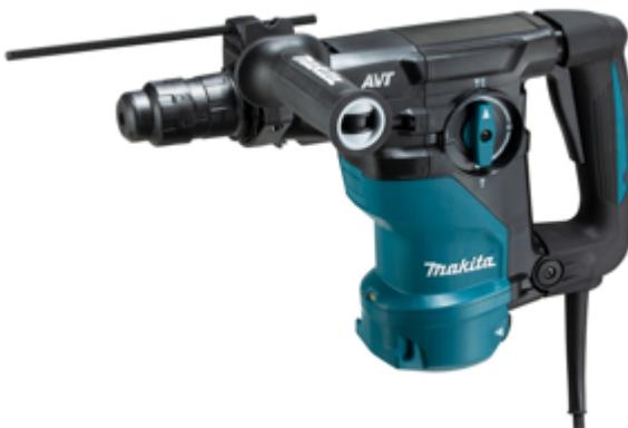
Potente tassellatore SDS-Plus compatibile, con esclusivo sistema antivibrante AVT. La macchina è dotata di 3 funzioni. La potenza del motore è di 1.050 W e la velocità è regolabile da 0 - 840 g/min. La macchina raggiunge una forza di impatto di 3,9 J. La capacità massima di perforazione nel calcestruzzo è di 30 mm.
