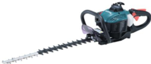
Tagliasiepi con motore a scoppio 2 tempi da 0,68 kW dotato di lama bilaterale da 60 cm affilata su tutti e 3 i lati. Ideale per lunghe siepi. Impugnatura girevole per la massima versatilità di utilizzo. Cinque posizioni della maniglia posteriore. Rispetta le più rigide normative sulle emissioni dei gas di scarico nocivi. Lo scarico delle emissioni è posto in posizione frontale. Sistema antivibrante con molle di acciaio per lavorare in sicurezza.
