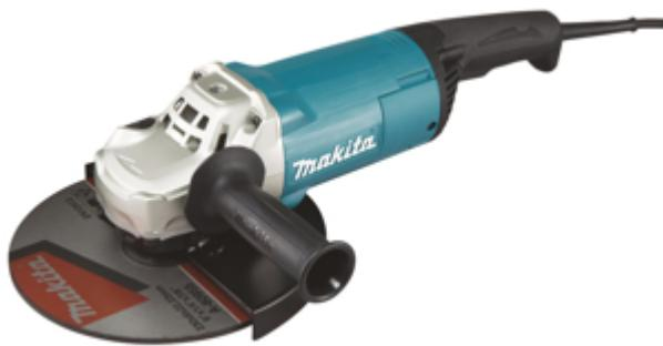
Smerigliatrice angolare 2.200 W con una grande disco da 230 mm per applicazioni impegnative che richiedono elevate portate. Interruttore palmare per avviamento facile e rapido. Sistema di protezione dalle polveri ottimizzato con cuscinetti sigillanti e parti elettriche ricoperte da vernici di protezione. Impugnatura laterale antivibrante AVT. Sostituzione disco senza attrezzi.
