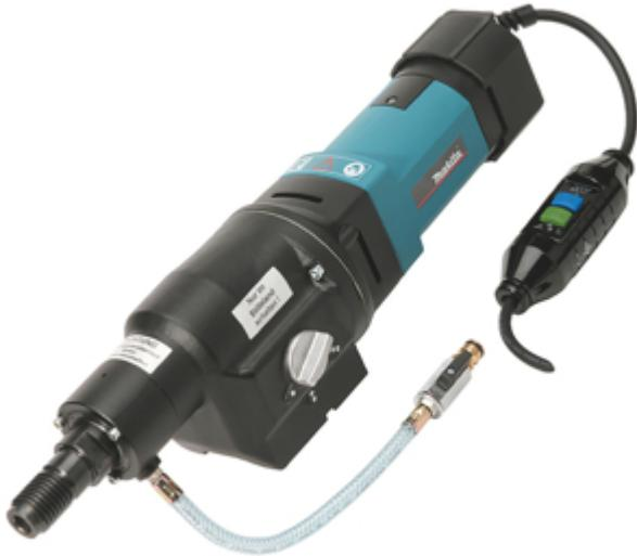
Carotatrice 2.500W con supporto (cod. P-40098) dotata di avviamento lento per esecuzione di fori ad umido di elevato diametro (fino 230mm) e profondità: in muratura, cemento e pietre, da utilizzare esclusivamente con l'apposito supporto. Dotata di salvavita per utilizzo in sicurezza (interruttore PRCD), frizione meccanica e sensore termico. Fornita con supporto per carotatura ad umido, interruttore salvavita.
