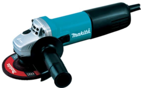
Smerigliatrice angolare 115 mm motore da 840W (velocità a vuoto 11.000g/min) compatta con interruttore a slitta di facile azionamento, sistema anti riavvio per la massima sicurezza. Protezione dalle polveri ottimizzata con cuscinetti sigillati e con parti elettriche ricoperte da vernici di protezione. Tasto blocco disco. Cavo di alimentazione 2,5m. Fornita con due dischi e valigetta.
