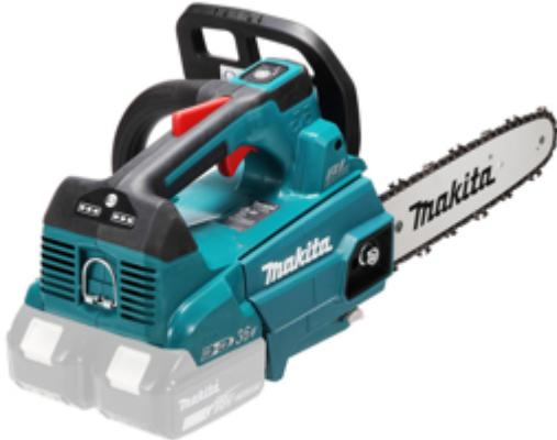
Elettrosegna con barra per intaglio dotata di un potente motore brushless alimentata da due batterie Li-ion da 18V con una velocità della catena di 20 m/s. Dotato di una barra di guida stretta da 250mm. Il sistema XPT permette l'utilizzo in presenza di polvere e gocce d'acqua. Ideale per sramatura e abbattimento di piccoli e medi arbusti. Fornito senza batterie e caricabatterie.
