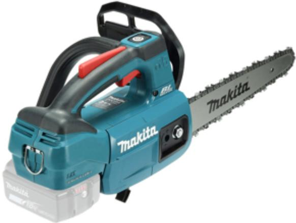
Elettrosegna ergonomica e maneggevole con barra per intaglio ha una velocità della catena di 22,5 m/s. Dotato di una barra di guida stretta da 250mm, ideale per l'intaglio. Il sistema XPT permette l'utilizzo in presenza di polvere e gocce d'acqua. Ideale per la sramatura e l'abbattimento di piccoli e medi arbusti. Fornito senza batterie e caricabatterie.
