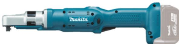
Avvitatore angolare a velocità costante con controllo di coppia meccanico brushless da LXT® 14,4V con attacco quadro da 3/8" per lavori di installazione industriale. Il campo di fissaggio è di 5,0 – 12,0 Nm e la precisione è di +/- 10%. L'utensile si spegne automaticamente una volta raggiunta la coppia desiderata e una funzione soft start offre un maggiore comfort. Regime del motore di 1.200 giri/min. Fornito senza batterie e caricabatterie.
