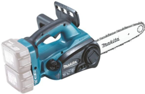
Elettroseg a batteria compatta con una velocità della catena di 8,3 m/s. Un'elevata tensione di 36 V si ottiene con due batterie LXT® da 18 V. LED con segnalazione carica residua della batteria.
