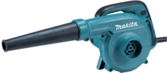
Un soffiatore da 600 W leggero, compatto e silenzioso per macchine da giardinaggio o per la pulizia dei cantieri. Dotato di controllo continuo della velocità dell'aria e un tubo di soffiaggio corto. Flusso d'aria max di 91 m/s e volume d'aria di 4,1 m<sup>3</sup>/min.
