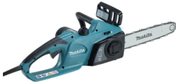
Una potente elettrosegna dritta da 1.800 W con un'elevata efficienza di taglio. Dotato di una funzione di avviamento graduale, questo è un ottima elettrosegna multiuso per i cantieri e l'uso domestico. Barra da 40 cm e velocità della catena di 14,5 m/s. Dotato di pompa dell'olio regolabile e regolazione della tensione senza attrezzi.
