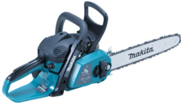
Motosega compatta dotata di barra guida da 35cm e un motore da 1,35Kw che genera una velocità di catena di 24,4 m/s. Sotato di funzione Easy start e regolazione laterale della barra e della catena senza attrezzi. Marmitta catalitica per conformarsi a tutte le normative sulle emissioni. Fornito in dotazione barra35cm, copribarra, catena, chiave.
