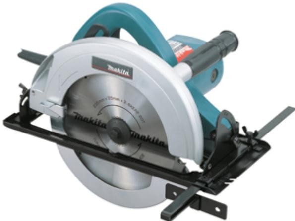
Una sega circolare ad alta capacità efficiente e robusta con un motore da 2.000 W e una velocità di 4.100 giri/min progettata per un uso professionale. Compatibile con una lama con diametro di 235 mm che raggiunge profondità max di taglio di 85 mm.
