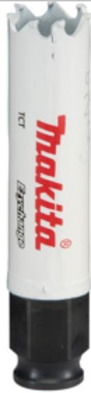
Sega a tazza realizzata TCT, l'innovativa geometria del dente garantisce lunga durata e velocità di taglio su acciaio, acciaio inox, alluminio, metalli non ferrosi, legno, PVC, mattone e pietra calcarea fino a una profondità di taglio di 60mm. Il sistema di cambio rapido EZYCHANGE consente di sostituire la tazza senza attrezzi.
