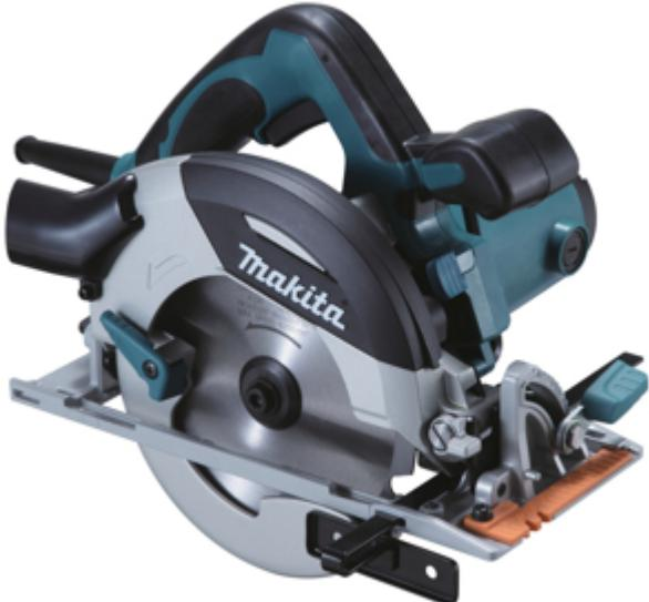
Sega circolare dotata di motore da 1.100W, e carter della lama con ampia bocchetta di aspirazione. Sono presenti i riferimenti di guida regolabili per un migliore controllo dei tagli perpendicolari o inclinati. Blocco dell'albero per una facile sostituzione della lama. Sono presenti scale graduate ben leggibili per facilitare i tagli inclinati. Cavo di alimentazione 2,5m. Accessori in dotazione: Lama in HM, guida laterale graduata, chiave, valigetta makpac tipo 4 (821552-6).
