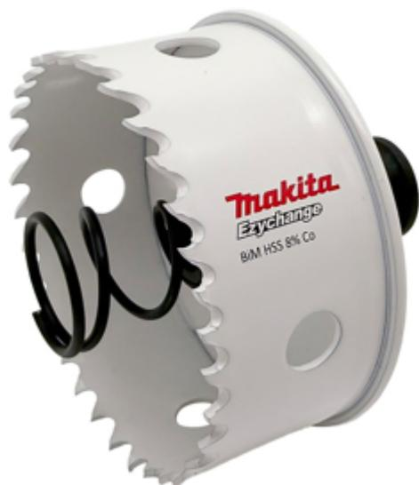
Sega a tazza realizzata in bimetallo HSS con l'8% di cobalto, specifica per lamiera metalliche (acciaio, inox, alluminio e metalli non ferrosi). Il sistema di cambio rapido EZYCHANGE consente di sostituire la tazza rapidamente e senza attrezzi. Questa particolare serie è dotata di molla per l'espulsione della lamiera e di flangia stopper antisfondamento.
