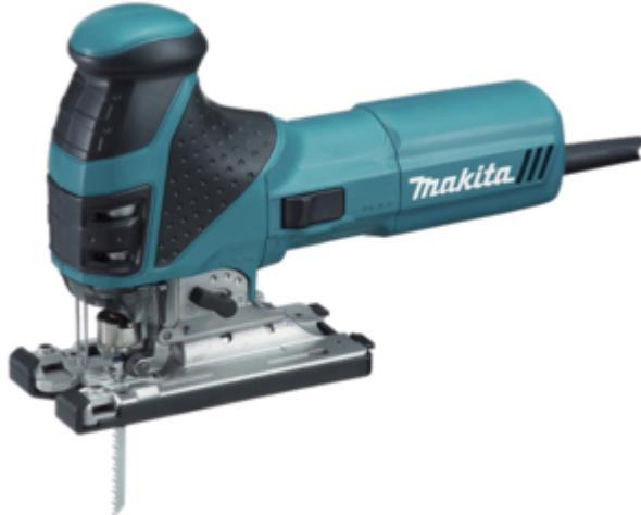
Seghetto alternativo 26 mm, taglio orbitale regolabile in 3 posizioni, cambio lama senza attrezzi. Piastra in alluminio regolabile da 0° a 45° su 2 lati. Capacità taglio legno 135 mm. Impugnatura ergonomica con rivestimento soft grip. Possibilità di collegare l'aspiratore mediante apposito adattatore. Fornito con valigetta MAKPAC.
