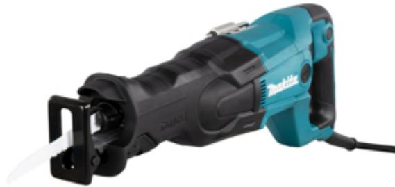
Seghetto diritto base per il taglio senza scintille di metalli e lavori di demolizione. Un efficiente motore da 1.250 W, lunghezza della corsa di 32 mm e frequenza di corsa da 0 a 3.000 c/min con controllo continuo dall'interruttore. Attacco lama a sgancio rapido.
