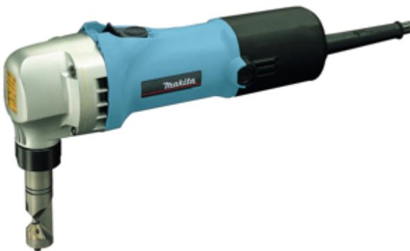
Una roditrice snella che realizza tagli curvi e dritti precisi e dai bordi netti. Ideale per il taglio di lastre profilate, come materiali per tetti. La matrice ruota di 360°. Una capacità di taglio di 2,5 mm per l'alluminio e 1,6 mm per l'acciaio. Potenza del motore di 550 W e una frequenza di corsa di 2.200 giri/min. Fornito con valigetta makpac
