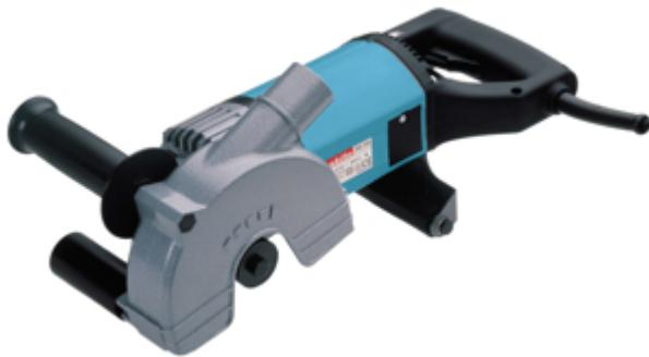
Uno scanalatore a doppio disco da 1.800 W con elettronica costante che taglia scanalature precise nel calcestruzzo e mattoni per cavi o tubi, ad esempio, senza generare polvere. Due dischi diamantati in funzione contemporaneamente. Profondità di taglio massima di 45 mm, con una larghezza regolabile di 7 – 35 mm. Dischi diamantati non inclusi.
