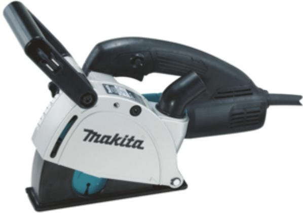
Uno scanalatore da 1.400 W a doppio disco con elettronica costante che taglia scanalature precise nel calcestruzzo e nei mattoni senza generare polvere. Due mole diamantate in funzione contemporaneamente. Profondità di taglio massima di 30 mm, con una larghezza regolabile di 6 – 30 mm. Dischi diamantati inclusi. Fornito con valigetta makpac
