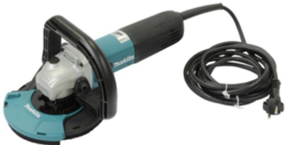
Una pialla con disco da 125 mm per una levigatura efficiente e senza polvere del calcestruzzo. Il suo potente motore da 1.400 W eroga 4.000 - 9.000 giri/min per operazioni efficienti. Protezione antipolvere rimovibile consente la piallatura a filo parete. La tecnologia SJS II fornisce un meccanismo di azionamento progettato per ridurre le vibrazioni e aumentare il comfort. Disco non incluso.
