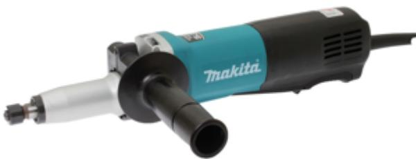
Smerigliatrice diritta leggera con una pinza da 8mm con interruttore palmare per un avviamento rapido. Dotato di elettronica a velocità costante e tecnologia SJS per proteggere l'utente dal contraccolpo. Adatto per la rettifica su piccola scala, inclusa la rimozione delle bave, con il telaio lungo che offre una buona portata. La velocità può essere regolata tra 1.800 – 7.000 giri/min. Cavo di alimentazione 2,5 m. Accessori in dotazione: Impugnatura laterale, 2 chiavi.
