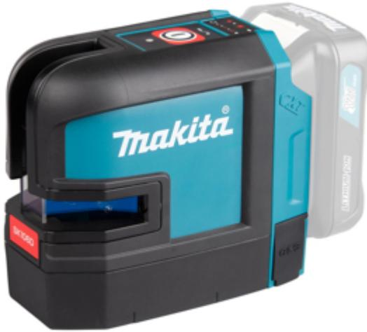
Un tracciatore laser autolivellante a righe verticali e orizzontali rosse utilizzabile separatamente o insieme. Punta i laser su e giù, sinistra e destra. Visibilità di 25 metri. Tutte le funzioni sono facili da usare con un solo pulsante. Il laser è resistente alla polvere e all'acqua con grado di protezione IP54 e la sua autonomia con una batteria da 4,0 Ah è di circa 40 ore. Fornito senza batterie e caricabatterie
