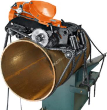
Fresatura di tubi di 250 mm - 1.500 mm di diametro
