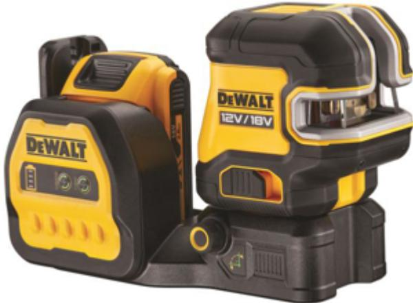
**Tracciatore laser raggio verde, proietta 2 linee a croce 90° e 5 punti (2 piombo + 1 frontale + 2 laterali a 90°). Luce pulsante costantemente attiva, classe 2 (510-530nm). Autolivellamento +/-4°, Precisione +/- 3mm/10m, portata 30m 1 x 18V**
