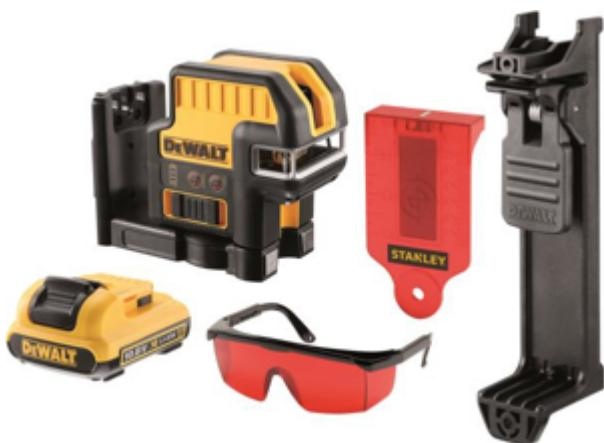
**Tracciatore laser raggio rosso, classe 2. 2 linee a croce orizzontale e verticale + 2 punti a piombo. Autolivellante +/- 4°. Precisione +/- 3 mm a 10 metri 1x 12V**
